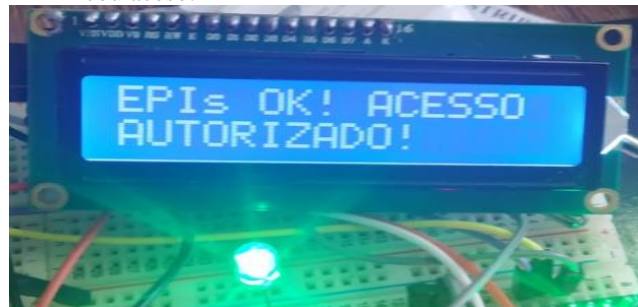
Figura 23 – Display informando que o acesso ao local foi autorizado e para verificação de tensão da porta digital o LED ficou aceso.
