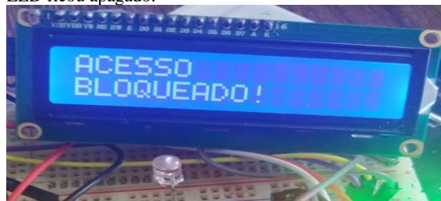
Figura 24 – Display informando que o acesso ao local foi bloqueado e para verificação de tensão da porta digital o LED ficou apagado.
