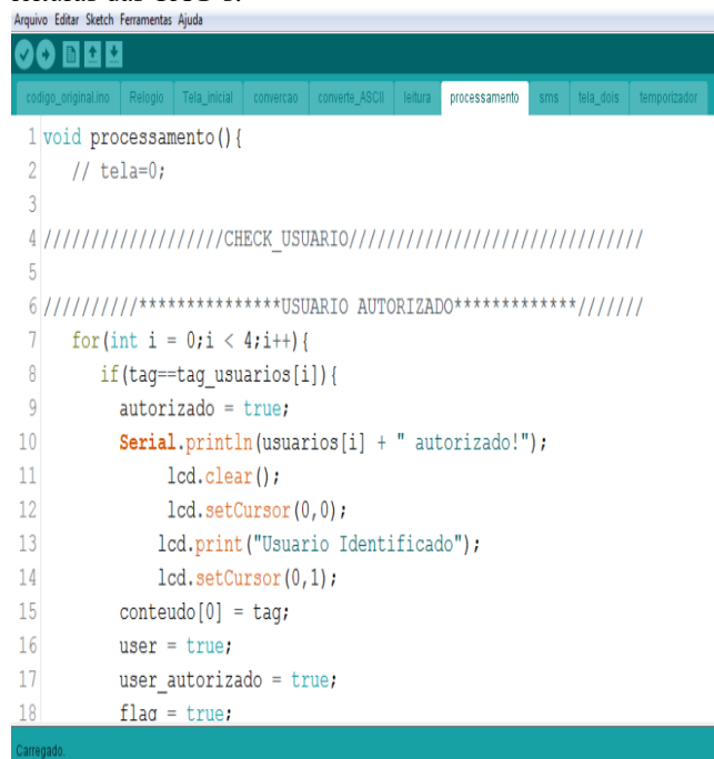
Figura 17 - Algoritmo de processamento para realização das leituras das TAG's.
