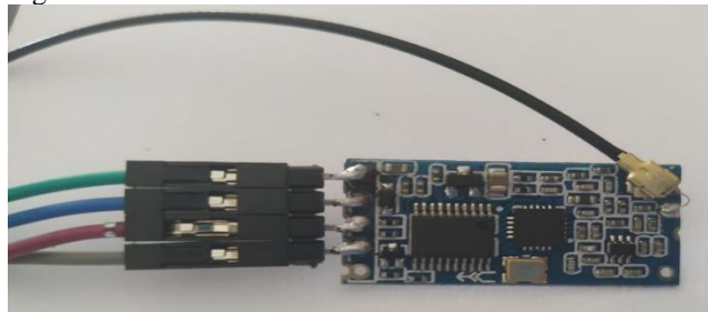
Figura 14 – Módulo Wireless HC12.
