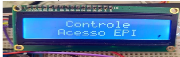
Figura 16 – Display utilizado para informar se o acesso foi autorizado ou bloqueado.
